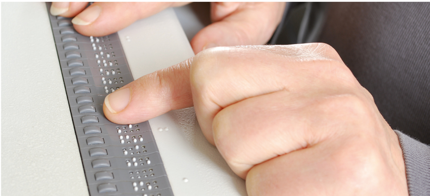
Der aktuelle Bildschirminhalt quasi als Newsticker in Blindenschrift: Die Braillezeile orientiert Blinde detailliert über alles, was auf dem Monitor gerade angezeigt wird.
